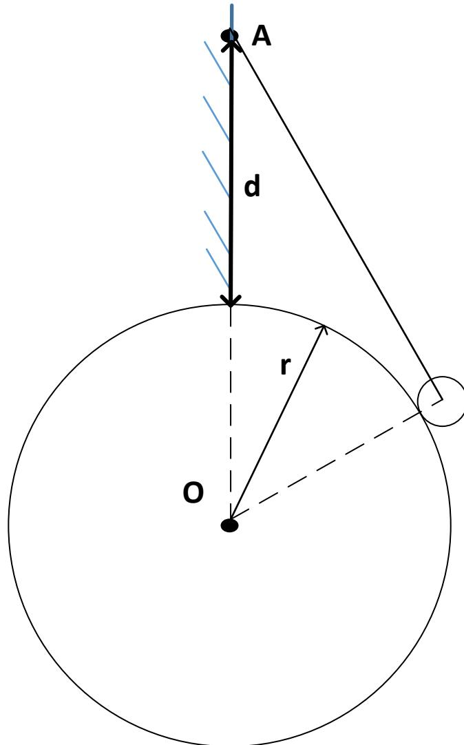
**Rešenje:** Primena teoreme o ravnoteži tri sile, sličnosti trouglova i sinusne teoreme.
