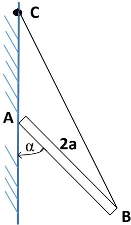
**Rešenje:** Primena teoreme o ravnoteži tri sile, sličnosti trouglova i. Slični trouglovi su CKB i trougao oab koji čine vektori tri sile.
