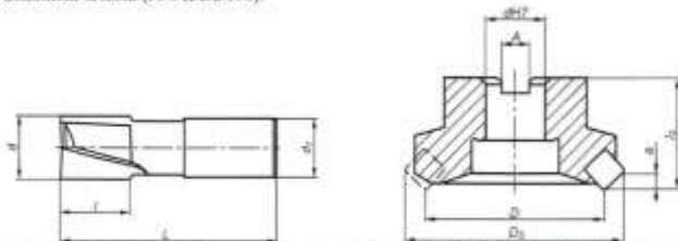
Silka 23. Glodalo za žljebove sa valjkastom drškom (JUS K.D2.110) i glodačka glava S – MAX 145 RG60.22.
